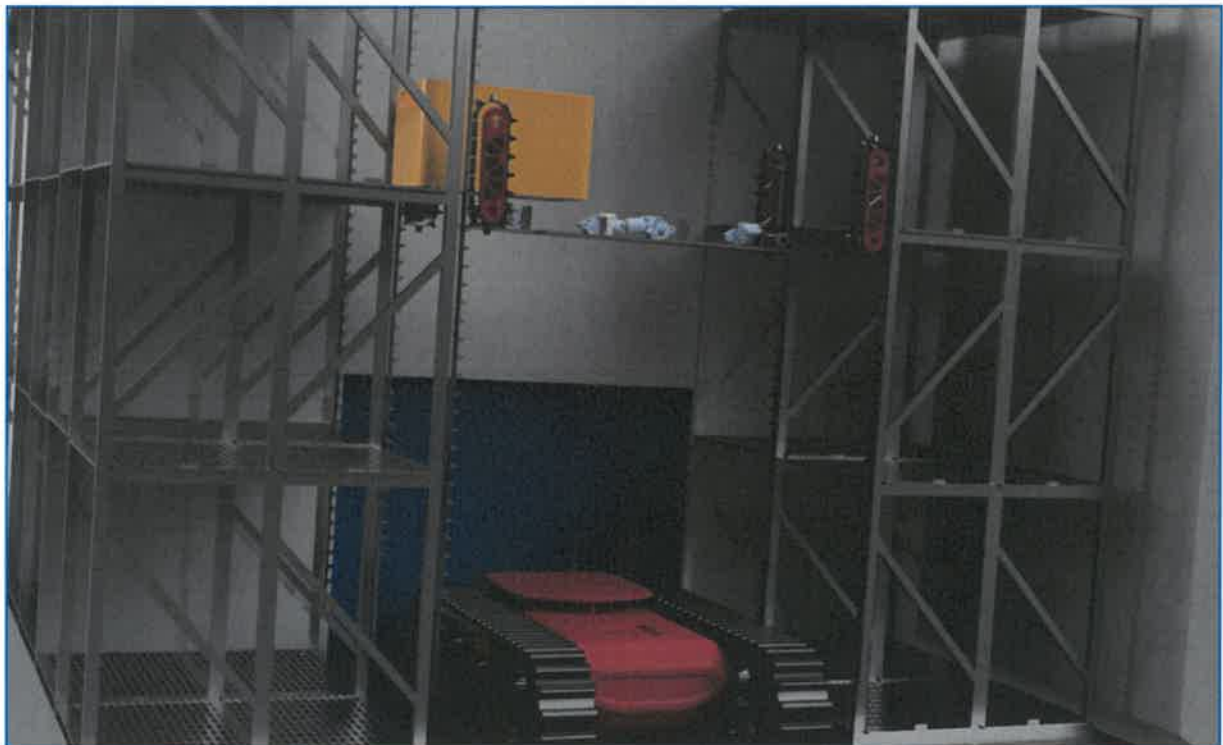
Rys. Przekazanie kosza z platformy na stelaż.
