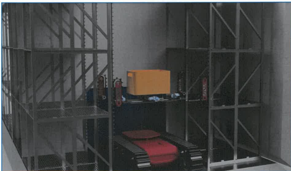
Rys. Transport kosza w pionie za pomocą platformy.
