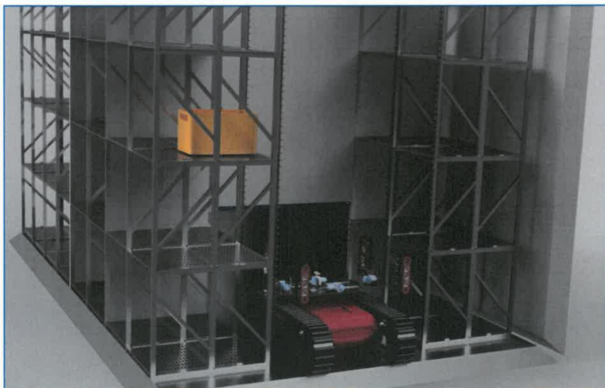
Rys. Powrót platformy na robota samojezdnego.
